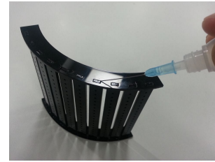
Fig.1 アクリルサンデーを溝に流し込むと, ちょっと隙間があってもアクリルが溶けてくっついてくれる.
