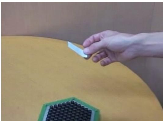
Figure 1: 超音波によって紙が押し上げられている様子。
