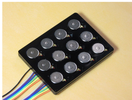
Fig. 3 運筆軌跡を提示する振動子アレイ。平面上に 12 個の振動子を 17 mm 間隔で配置している。
