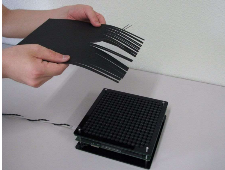
図2 空中超音波触覚ディスプレイ。超音波焦点により紙片の一部が押し上げられている。
