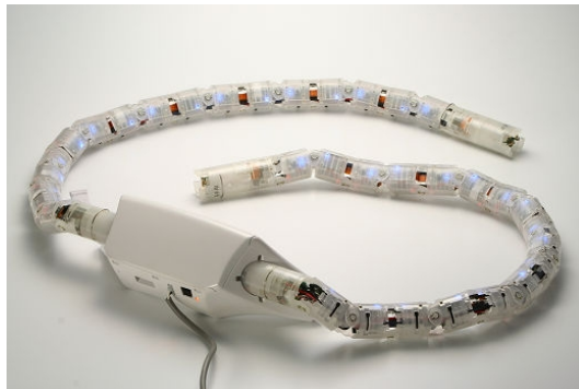
図 2.8 フレキシブルセンサチューブ [62]. 各関節にポテンショメータが組み込まれている.
