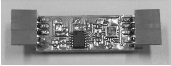
Fig. 9 Sensor chip (14 × 38 mm<sup>2</sup>).
