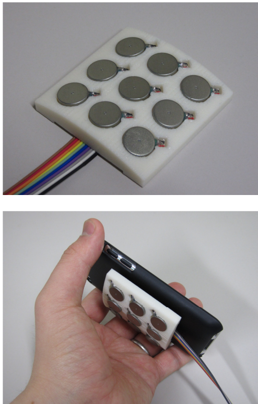
Fig. 4 (上) 運筆軌跡を提示する振動子アレイ。曲面上に9個の振動子を17 mm 間隔で配置している。(下) iPod touchの背面に取り付けた様子。曲面により図3の振動子アレイと比較して手掌部との密着性を高めている。
